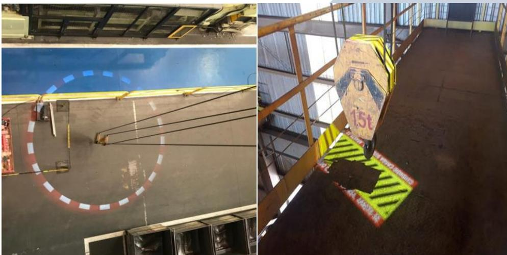
FIGURA 11 - PROJOTOR INSTALADO EM PONTE ROLANTE
